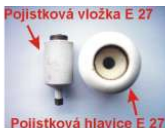
Obr. 17. Příklad tavné vložky a porcelánové hlavice závitové pojistky
