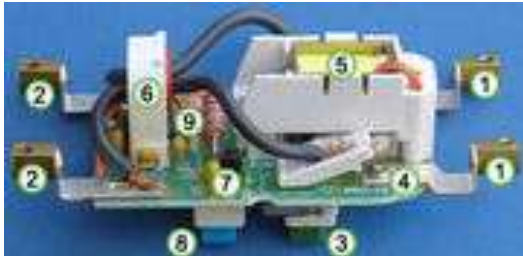
Obr. 28 Vnitřní zapojení proudového chrániče:
